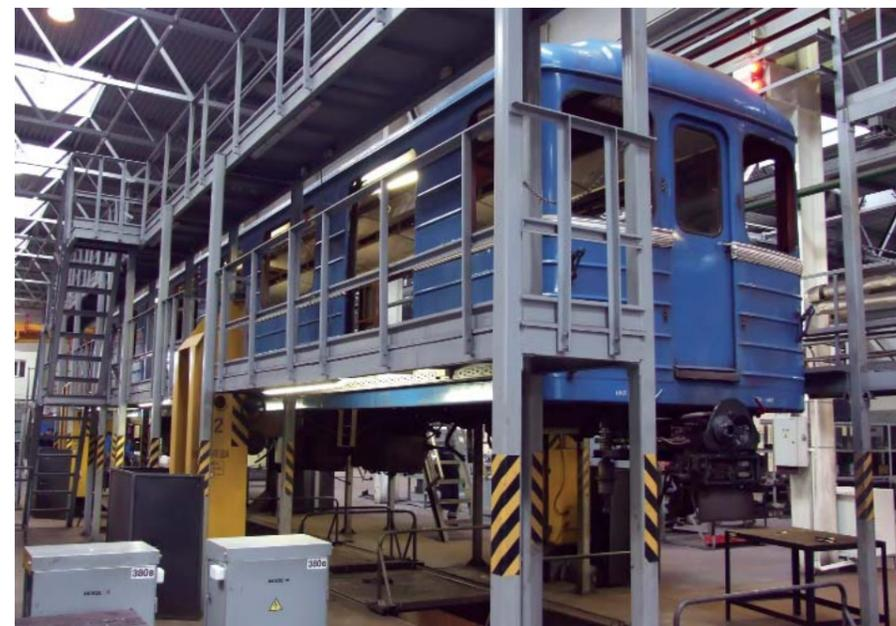
ление по подготовке к окрашиванию и малярное отделения. Малярное отделение по технологическим причинам было разделено на участок кузовного ремонта и участок окраски кузова вагона. В этих отделениях производилась замена электропроводки, освещения и вентиляции.
