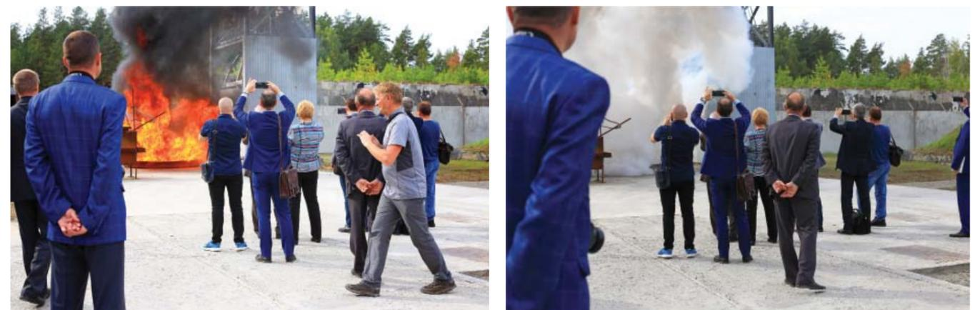
Фазы испытания порошкового модуля пожаротушения «Тунгус» на полигоне
