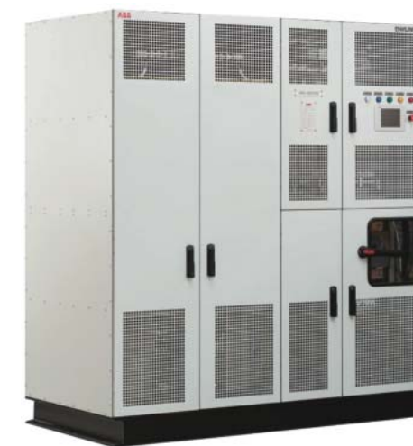
Характеристики: • базовая система 500 кВт; • Инвертор И + Шкаф управления ШУ; • степень защиты: IP21; • габариты: 2.0 x 2.2 x 1.0 [м] (WxHxD); • масса: 2100 кг; • охлаждение: принудительное воздушное.
